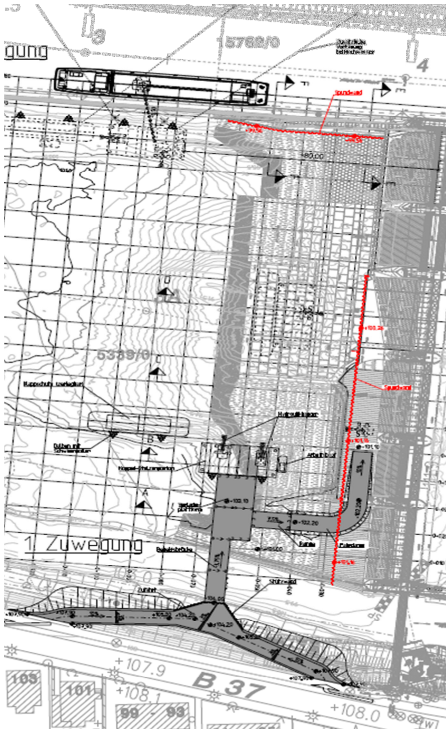
Abbildung zeigt mit den beiden roten länglichen Linien, wo die Spundwände eingebracht werden
